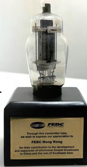
這個貌似電燈泡的玻璃小物，與福音廣播事工有何關係？答案只有一個，它並不是電燈泡，它是短波廣播發射機的一個重要零件——真空管！真空管可說是發射機的靈魂，它能控制發射機內的電子流動，從而將電波放大而產生廣播所需要的高頻率無線電波。
